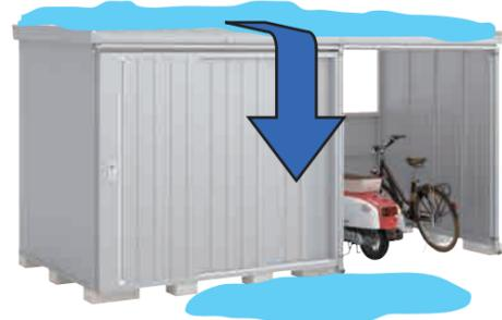
扉の位置が変更できる扉枠方式(壁面扉)を採用しています。扉の位置を後面に変更することで、屋根の傾斜が前流れとなり、後面の敷地に雨や雪を流さない配慮ができます。
